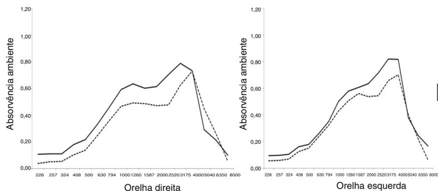
**Figura 1** Comparação dos valores médios da absorvância acústica na pressão ambiente por grupo, frequência e orelha.
