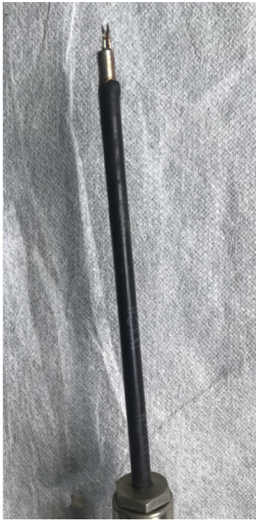
Figura 1 Imagem detalhada da ponta da antena de micro-ondas.
